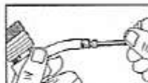
Σχέδιο 7 – Βιδώστε τη βαλβίδα (μπεκ ψεκασμού) στο περιστρεφόμενο στέλεχος του ρυθμιστή και ανοίξτε την παροχή αερίου.
